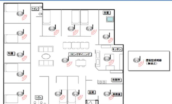
受信機、総合盤、中継器はなく、警報機能付きの感知器で、1つの感知器が発報すると、他の感知器も無線で連動して、警報音を鳴動させる。(但し、現在の住宅用警報器では、基準に満たず使用できません)
