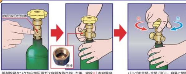
薬剤貯蔵タンクから加圧用ガス容器を取り外した後、密栓①を容器弁に取り付けるなど、容器からガスが漏れないように措置します。
