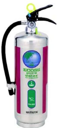
純水をベースとし、塩類を含まないため残留物がほとんどありません。P R T R 法指定物質不使用、pHは中性で人や環境にやさしい消火薬剤です。浸潤剤の働きにより安定した消火効果を有しています。電気伝導率は、 $10 \mu\text{S}/\text{cm}$ 以下と極めて低く、水道水の約 $1/20$ （当社比）です。クリーンルーム内やコンピュータールーム等で安心してご使用いただけます。
